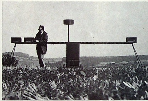
Bild 2. Mobile Anlage SETAC-A, arbeitsfähig aufgebaut
